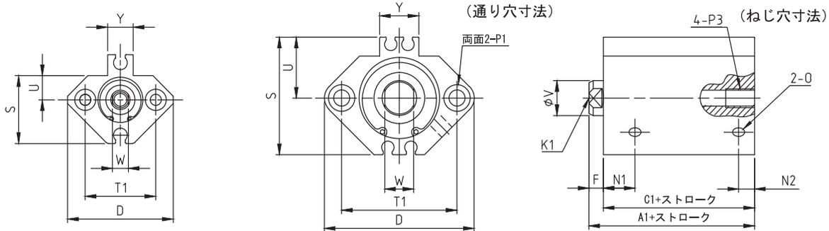
● 内径:  $\phi 32$ 、 $\phi 40$ 、 $\phi 50$ 、 $\phi 63$ 、 $\phi 80$ 、 $\phi 100$
